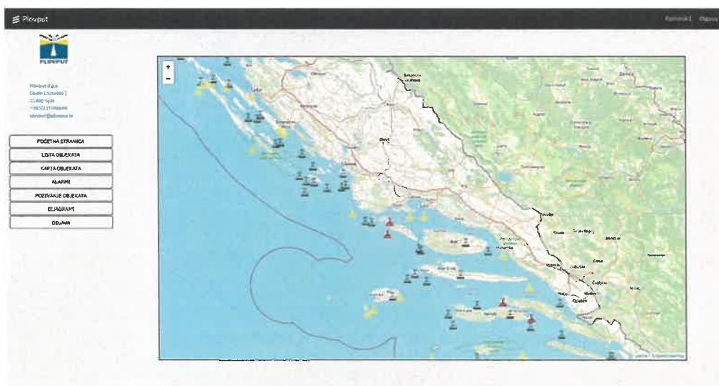
Slika 4. Sustav daljinskog nadzora svjetionika
